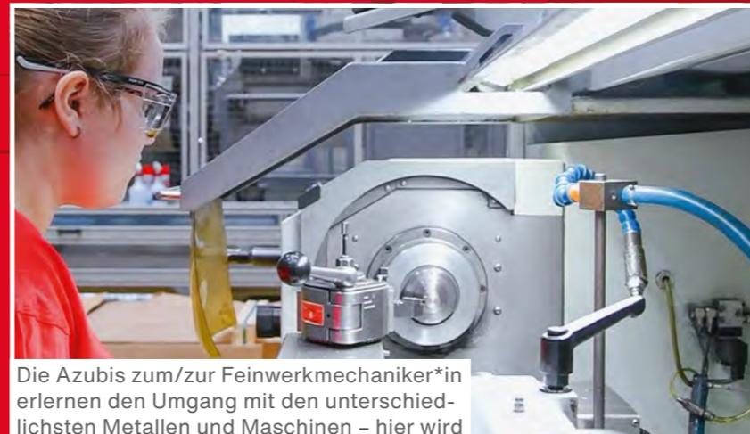
Die Azubis zum/zur Feinwerkmechaniker\*in erlernen den Umgang mit den unterschiedlichsten Metallen und Maschinen – hier wird ein Werkstück „gedreht“.
